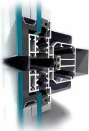
В системе MB-SG50 стекла крепятся к алюминиевым модулям при помощи специального конструкционного силикона. Подготовка модулей производится в фабричных условиях, что гарантирует соответствующее качество элементов и сокращает время монтажа на стройплощадке. Термоизоляционная вставка в профилях, а также тройная система уплотнения обеспечивают хорошую изоляцию конструкции, инфильтрацию воздуха и водонепроницаемость.
